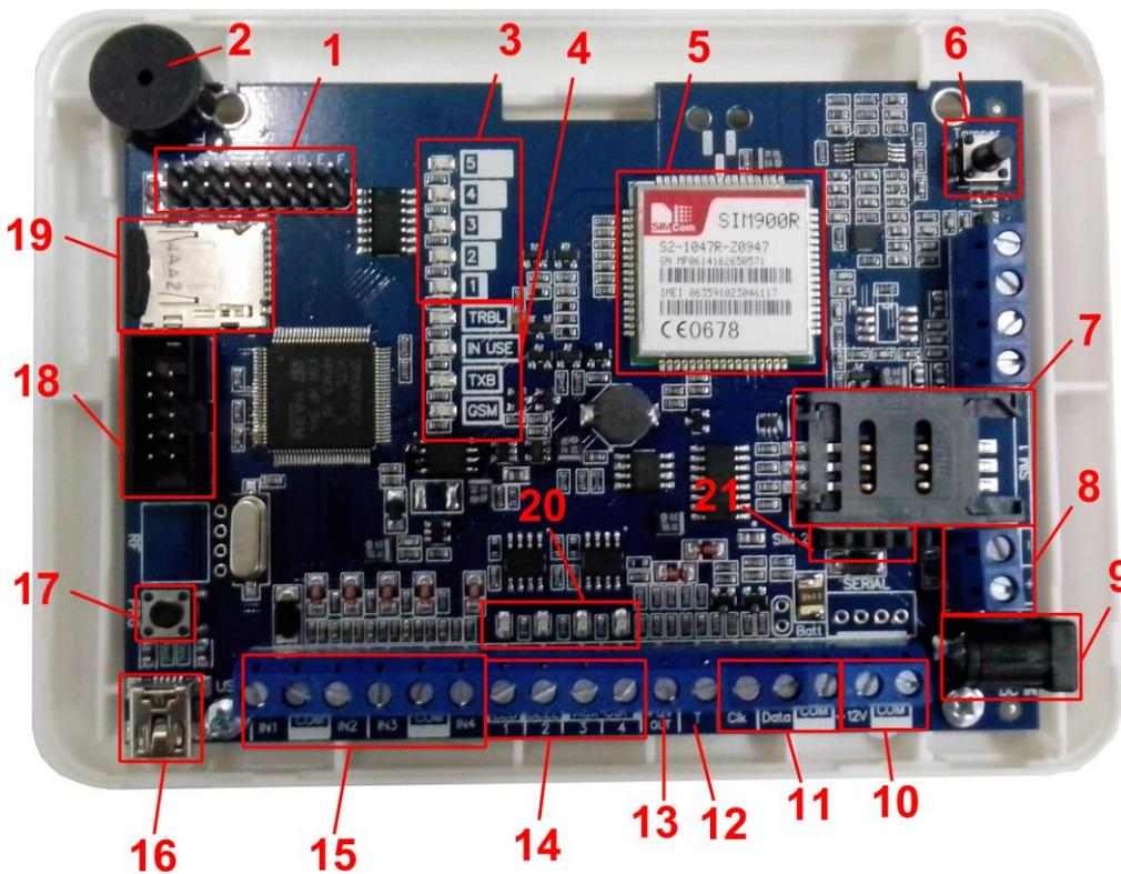
1 – группа перемычек. Используются для выбора режима индикации, сброса настроек, обнуления буфера событий и программирования ключей ТМ. В обычном состоянии все перемычки должны быть сняты.
